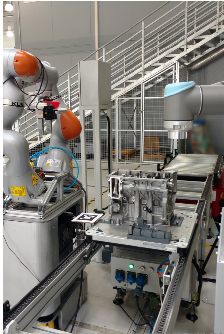
FIGURE 5.6 – Robots collaboratifs sur plateforme mobile (à gauche)(source : projet ScalABLE 4.0)
